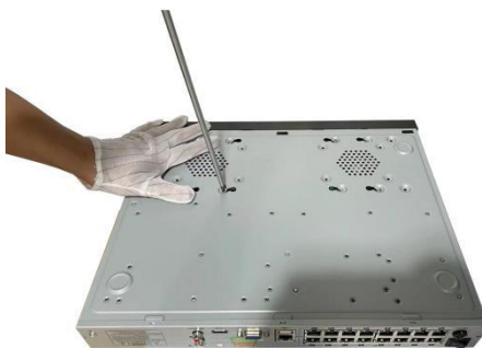
Zdjęcie 1-4-2 przykręcić dysk HDD
