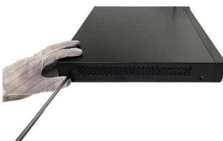
Zdjęcie 1-4-3 Zamontuj obudowę i ją przykręć
